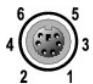
Figure B-3. Numéros des broches des connecteurs de clavier et de souris compatibles PS/2
